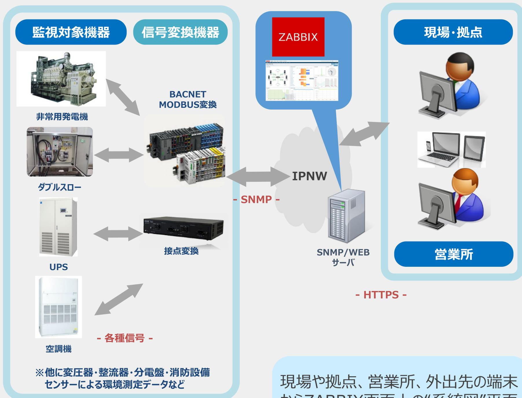
接点、SNMP、MODBUS、BACNETの様々な信号に対応
