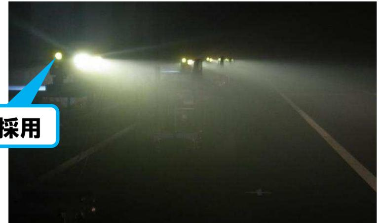
実環境実験施設 見え方試験 (高欄照明設置イメージ)
