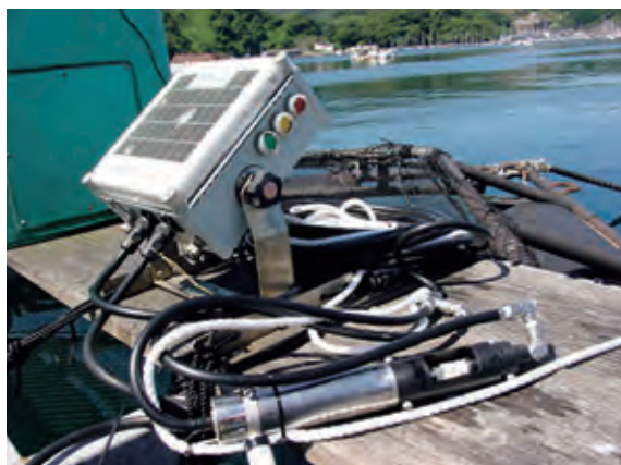
水温計と光学センサーを取り付けた例
