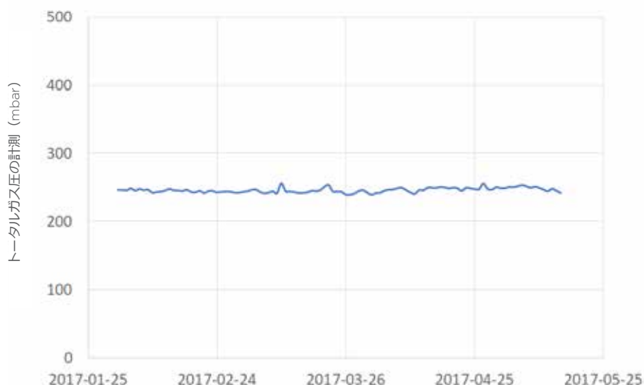
図 6. ヴァイサラ OPT100により計測された、29年間使用された変圧器の絶縁油中のガスの全圧
