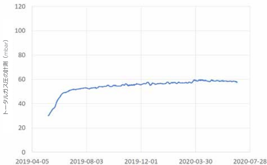
図5. ヴァイサラ OPT100により計測された、新品の変圧器の絶縁油中のガスの全圧
