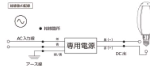
**仕様** RoHS 対応 CE 防雷 15kv 密閉 対応 PS E 360 入力電圧 :90V~242V セーフティワイヤー付
