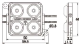
**仕様** 調光対応 防水IP65 PSE 16S 消色Ra80 入力電圧: AC100V 動作温度: (-20~55℃)
