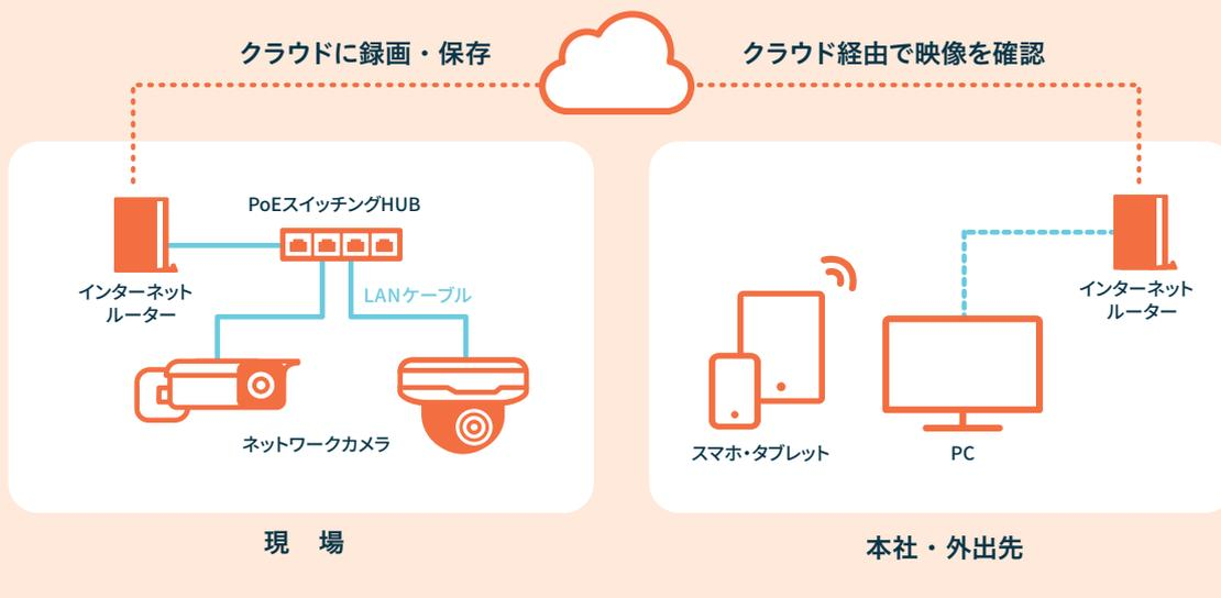
クラウド（クラウド・コンピューティング）とは、インターネットなどのネットワーク経由でサービスを提供する形態のことで、Antenna-eye ならネットワークカメラやウェアラブル対応 WEB カメラで撮影された映像がクラウド上に保存されるため、レコーダーやサーバーームは不要です。また、国内サーバーを利用しているため、安心してご利用いただけます。
