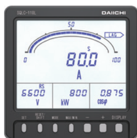
電力監視画面
