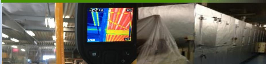
**遮熱シート**で熱を遮ることにより、建物内外の熱の移動をなくし、夏は涼しく冬は暖かく過ごせます。また、直貼り工法では乾燥炉などの機器の表面を覆うことにより、機器内部の温度の安定と大幅な省エネ効果が見込めます。
