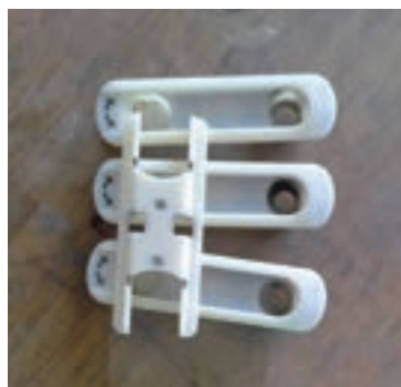
試作（樹脂サンプル） CNC加工機・3Dプリンターで制作
