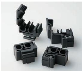
ソーラーパネルや架台フレームのエッジにはめ込み、ケーブルを挟むだけで簡単に配線施工ができる、作業性抜群の配線固定具です。横ズレ防止機能付きロック機構のカバーで、ケーブルのズレや外れを防止します。
