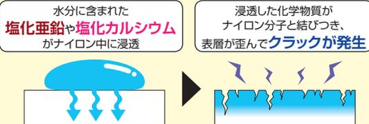
66ナイロン製結束バンドの破断は、塩害の影響によるソルベントクラックと紫外線による耐候性劣化からの破断の2種類があります。
