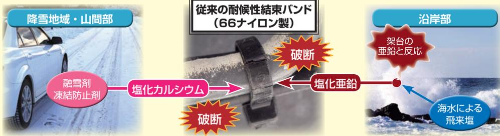
亜鉛めっき鋼板の亜鉛と海水に含まれる塩分が反応すると塩化亜鉛が発生し、短期間で66ナイロン製結束バンドを劣化・破断させます。降雪地域や山間部で散布される融雪剤・凍結防止剤の主成分である塩化カルシウムも66ナイロン製結束バンドを劣化・破断させる原因です。
