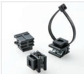
架台フレームのエッジにはめ込み、ガルバロックを併用して簡単に配線固定をすることができます。独自の爪クランプ機構を採用しているため、フレームのエッジにガッチリ食い込み固定でき、穴あけ・ビス止めも不要で作業効率がアップします。縦・横いずれの方向からもガルバロックを挿入することができます。
