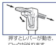
結束後もレバーを押すことでロックを解除できるため、繰り返し使用ができ経済的です。施工後、ケーブルを取り外して、再結束したい場合にご利用いただけます。11ナイロン製で、耐候性・耐塩害性・耐薬品性に優れています。
