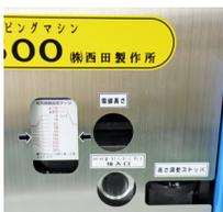
一般的にハンドル操作などでネジ高さを調整する機構は、長期使用時にネジのガタが発生、出荷時のバラツキ発生、精度を上げるためにネジピッチを小さくすることによるハンドル操作の固くなるなどの傾向があります。
