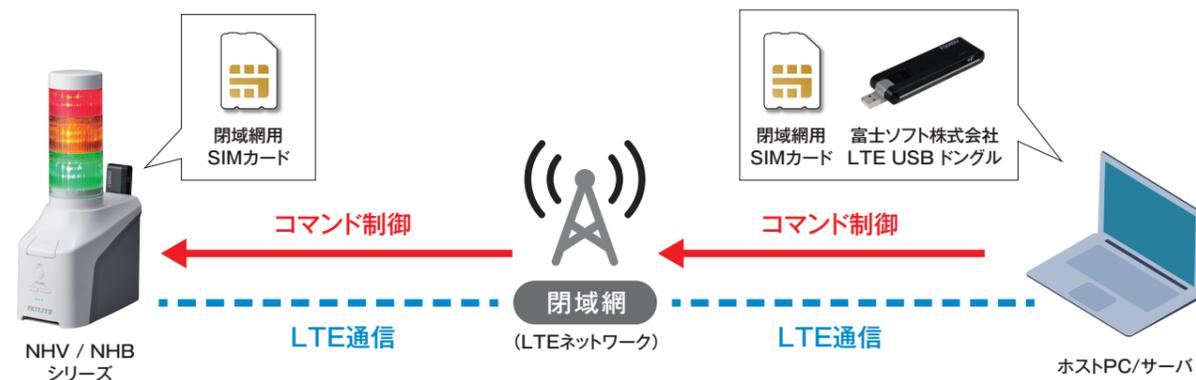
閉域網 SIM カードを使用することで、ホスト PC から LTE 通信を介して直接 NHV/NHB シリーズを制御できます。
