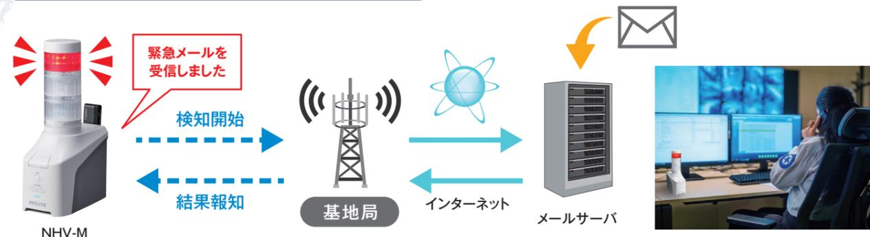
メール検知に対応した NHV-M モデルは、LTE ドングル経由でメールサーバにアクセスできます。
