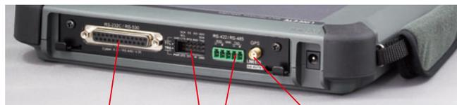
RS-232C/RS-530 計測ポート TTL計測ポート/外部トリガー端子 RS-422/485 計測ポート GPSアンテナ用コネクタ
