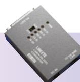
RS-232C機器をイーサネットLANに接続する通信変換器
