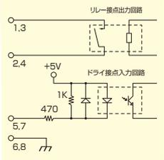
リレー接点出力:2点 ドライ接点入力:2点
