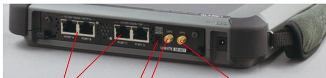
LAN計測ポート 外部入出力用端子 GPSアンテナ用コネクタ PPS信号用コネクタ
