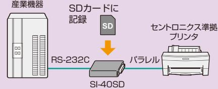
RS-232Cからの印字データをセントロニクス準拠パラレルに変換、印字データはSDカードに記録
