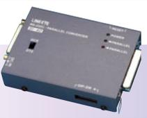
シリアル/パラレルを双方向に変換するRS-232C⇔セントロニクス変換器
