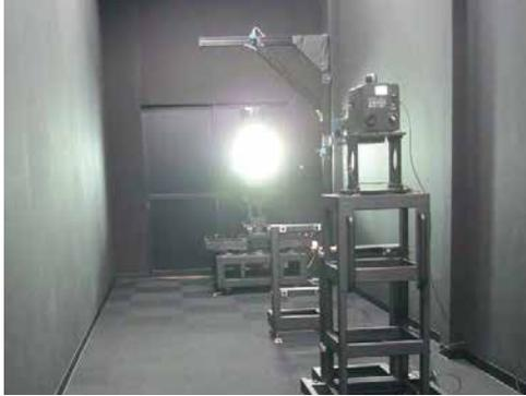
配光測定装置(照明実験棟)
