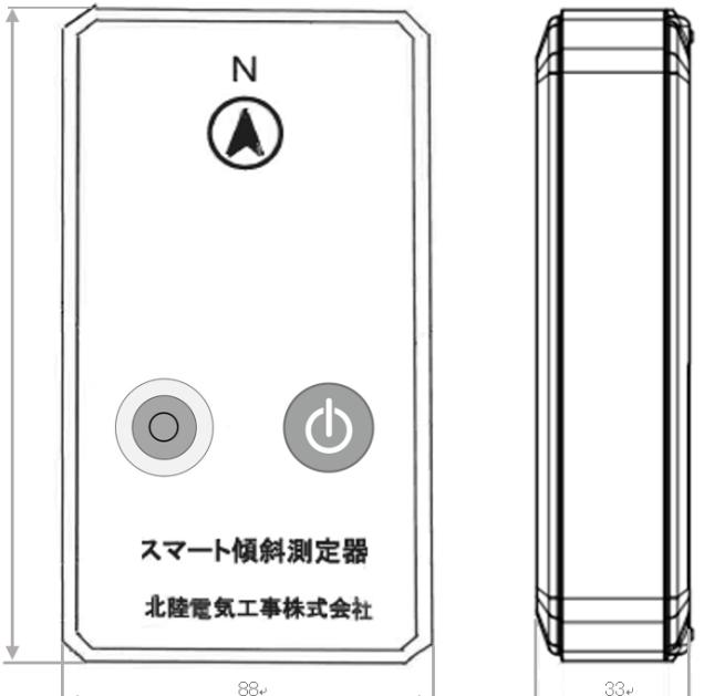
左側の図はスマート傾斜測定器の前面図で、右側には背面図があります。前面には「N」の北緯記号、二つのセンサー（電池ボタンとセンサー）があり、「スマート傾斜測定器」と「北陸電気工事株式会社」のロゴが表示されています。寸法は高さ146mm、幅88mm、奥行き33mmです。
