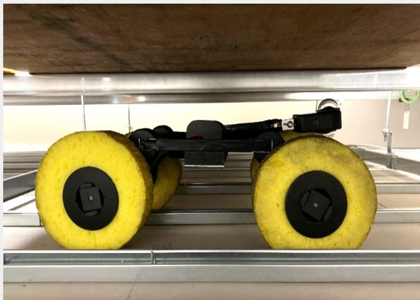
狭隘部への進入（天井内）
