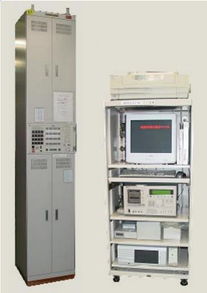
本装置は、地震発生の際に在来線沿線に設置されている地震計から、一定規模以上の地震情報を収集し、列車無線半複信方式を通じ、走行中の列車に対して予め決められた「音声情報」を自動的に放送し、的確かつ迅速な乗務員の制動操作により、速やかに列車を停止させ、被害を最小限に食い止めるものです。
