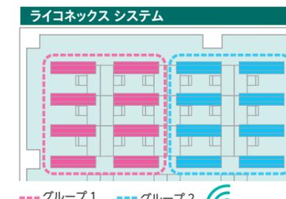
施工前に調光の回路設計が必要のため、設置後にレイアウト変更が生じた場合、グループ変更ができません。
