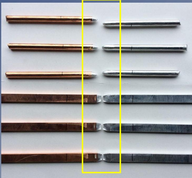
**引張**：接合面ではなく強度の弱いアルミ部分で破断
