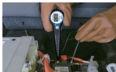
駆動用バッテリーの電圧測定
