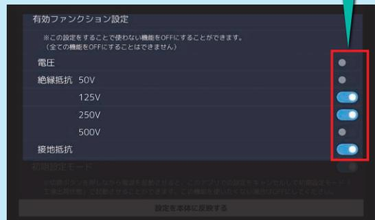
\*電圧機能をOFFにしても絶縁・接地抵抗機能の待機状態では電圧値を測定できます。
