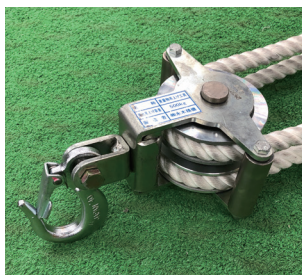
二連の動滑車で吊り荷の荷重を低減
