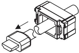
使用する(プラグ付き)ケーブルをホルダー裏側から表側に通し、配線に必要な長さに50mm程度プラスした長さをあらかじめ室内側に引き出しておきます。
