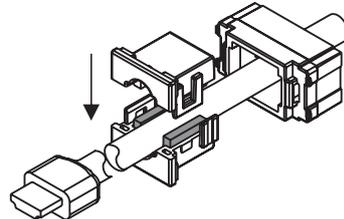
ホルダー表側開口部からできるだけ近い(50mm以内目安)で、ケーブルを2つのカバーで挟み爪を掛け合体させます。
