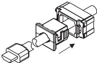
ホルダーに合体させたカバーを挿入します。
