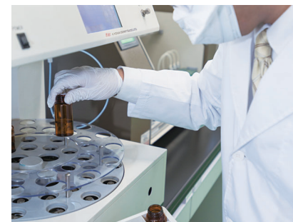
フルフラール分析装置 島津製作所製 脱気ユニット、送液ユニット1台、カラムオープン、マニュアルインジェクタ、UV-VIS検出器から構成されるシステムです。
