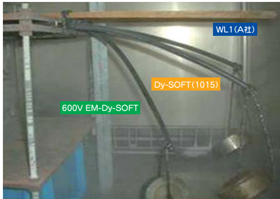
22mm 2 ・柔軟性他社比較試験結果(-40℃、重り1kg)
