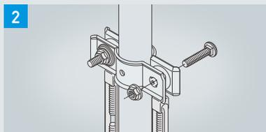
2 ターンバックルを金具に入れてからボルトを挿入、ナットを締め付けて完了です。
