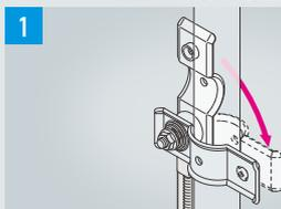
1 片側のボルトナットを取り外し、図のように金具を開き鋼管を挟み込みます。
