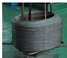
ヘッダー加工では、金属線(ワイヤー材)をヘッダーマシンに供給し、加工します。
