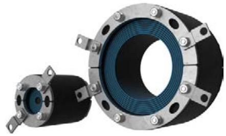
Roxtec RS UG™ は、建物基礎から引き込まれる単独配線や配管の周りに取付けやすい、2つに割れるシールです。水、ガス、湿気、ネズミに対して長期的なバリアを築きます。湿潤状態や流水下でも施工可能で、極端なケーブル屈曲にも耐えることができます。開口部寸法は、+5mm を許容するデザインで、シールの圧縮が十分かどうか確認できるインジケーターがついています。シールは、スリーブ、電線管、コアドリル孔に取付け可能です。
