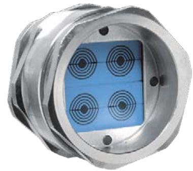
Roxtec RG M63 は、複数配線の引込口に適した丸型貫通部シールです。標準的なノックアウト径 ISO 63 サイズに合うデザインで、1~9本のケーブルを密閉することができます。真ちゅう (ニッケルメッキ加工) 製かステンレス鋼 (316L) 製から選択可能です。
