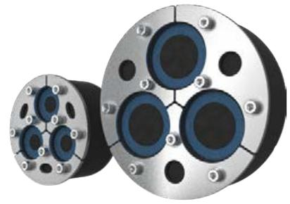
Roxtec H3 UG™ シールは、建物の基礎から引き込まれるケーブルに適したシールで、水、ガス、湿気、ネズミに対して長期的なバリアを築きます。3分割できるシールは施工性が高く、湿潤状態や流水下でも施工可能です。極端なケーブル屈曲にも耐えることができます。開口部寸法は+3mmを許容するデザインで、シールの圧縮が十分かどうか確認できる便利なインジケーターがついています。スリーブ、電線管、コアドリル孔に取付可能です。
