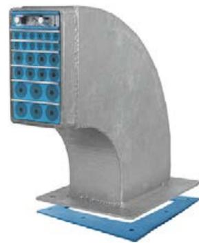
Roxtec Swan Neck 貫通部は、屋根上に取り付けられるよう設計されています。フランジ付きの拡張フレームで、1つか2つの開口部を備えています。さまざまなサイズのケーブル・パイプを1本から複数本シーリングすることができます。
