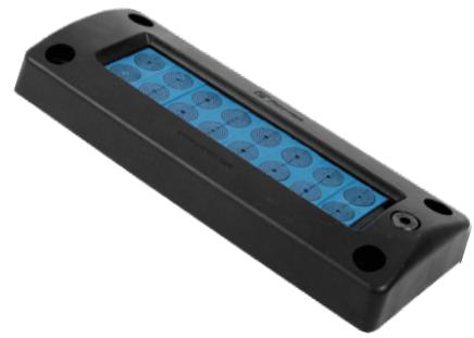
Roxtec EzEntry™ は、合成樹脂フレームを使った軽量型の貫通部シールで、標準的な開口部にフィットします。シールのサイズは6種類あり、4～32本の配線を収容可能。IP 66/67 の保護性能があります。
