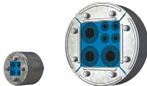
Roxtec R 貫通部 + SL R は、丸い開口部にスリーブとセットで使うケーブル・パイプ貫通部です。圧縮する機能が貫通部フレームに組み込まれていて、ゴムの膨張を利用して密閉します。標準モジュールは、異なる外径のケーブルやパイプに合わせて調整でき、将来のニーズに備えて貫通部に予備スペースを確保しておくことが可能です。下向き施工時に部品の落下を防止するため、背面にネットが張ってあります (R 70 と R 75 はネット無し)。スリーブは溶接で構造に固定します。
