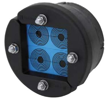
Roxtec CRL は、4 および 5 インチ穴用の丸型シーリングソリューションです。フレームの中には正方形のパッキングスペースがあり、シーリングモジュール、電線、パイプ、光ファイバーケーブルを収めてシール処理ができます。圧縮機能は、フレームに組み込まれています。
