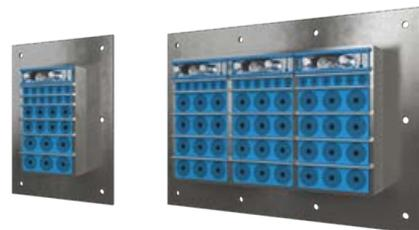
Roxtec GH は、コンクリートへ埋込むか、平らな構造面へボルトで固定して使う配線・配管貫通部シールです。この角型の鋼製フレームは、多数のケーブルやパイプを整理しながら高密度にシール処理することができます。GE 拡張フレームと組み合わせて使用すると、厚い壁の開口部にも対応できます。
