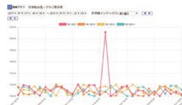
負荷電流や漏れ電流を高精度に測定することはもちろん、Bluetooth内蔵のスマートフォンやタブレットと連動することでサーバに測定データを蓄積でき、『設備不良の早期発見』や『劣化診断の目安』として活用することができます。
