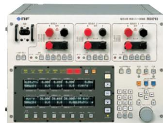
電流三相保護リレー試験器
