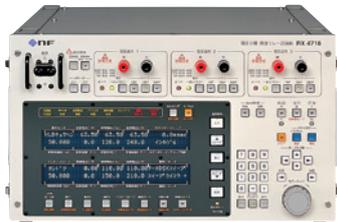
電圧三相保護リレー試験器
