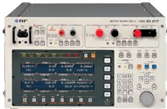
電圧単相電流単相保護リレー試験器
