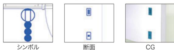
シンボルを選択し、配線の一括作図が可能。敷設方法ごとに設定した高さを参照して作図。配線とシンボルはリンクしているため、シンボルを移動するとそれに合わせて配線の形状も変更。
