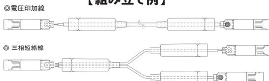
本製品に使用している電圧印加用の耐圧電線はDC50kV適応の仕様ですが、表面リークや誘導電圧・経年劣化により、ケーブル表面に電圧が発生します。
