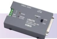
RS-232Cの極性(DTE/DCE)をスライドスイッチで切り替え可能
