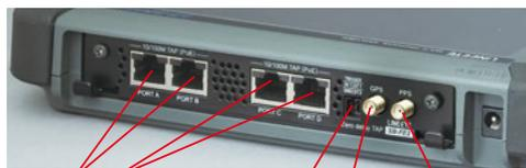
ゼロ遅延タップで、同時に2回線のLANパケットを高精度なタイムスタンプ付きでキャプチャできる拡張計測ユニット。EtherCAT回線のパケット計測に適しており、さらにPoE(Power over Ethernet)2回線同時測定も可能。機器の開発や、現場での障害解析などに活用できます。
