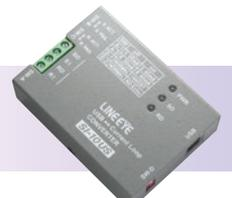
信号間に絶縁を施したFA向けのUSB⇔カレントループ変換器
