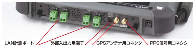
100BASE-T1、10BASE-T1L、10BASE-T1Sの3規格の計測・評価が可能、シングルペアーサネット計測対応の拡張計測ユニットです。適合機種にセットすることで、LE-8500X(R)-SEと同等機能のシングルペアーサネットアナライザーとして利用できます。
