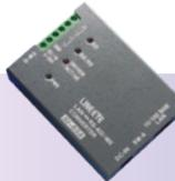
RS-422/485ポートを持つFA機器などをLANに接続する通信変換器
