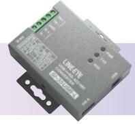
壁掛け設置用の筐体を採用したUSB⇔RS-422/485変換器
