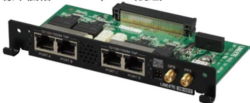
4つのLANポートで1Gbit Ethernetを2チャンネル同時測定
