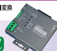
RS-422/485ポートにRS-45コネクタを採用した絶縁仕様の通信変換器
