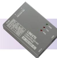
信号間に絶縁を施したFA向けのUSB⇔RS-422/485変換器
