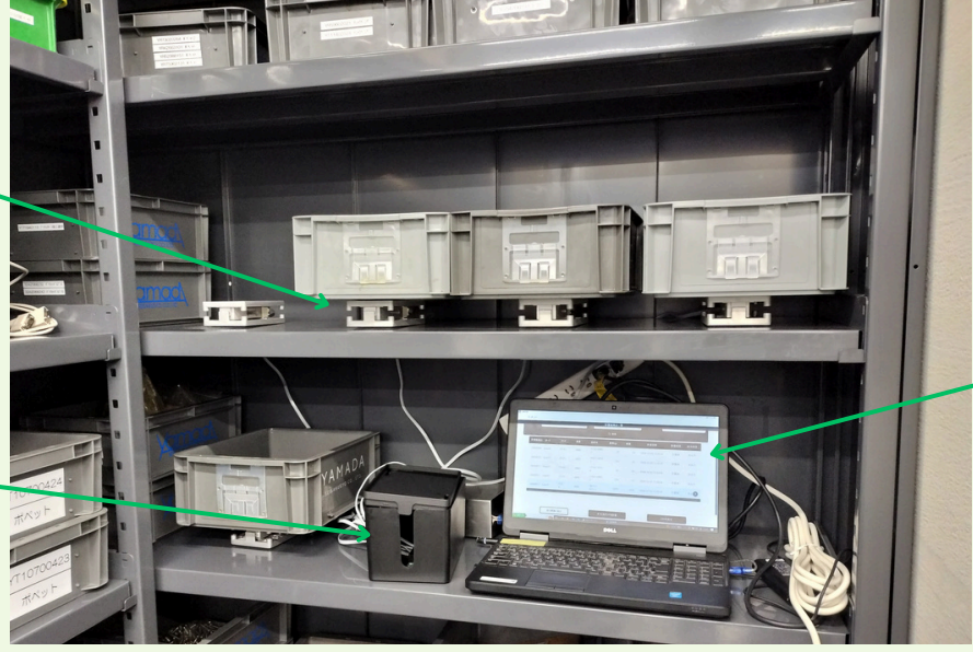
計量器のデータ信号を 変換する受信変換機あり
