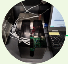
計量器のデータ信号を 変換する受信変換機あり
