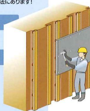
ゼロスペースボードの固定骨組としてはバタ角またはバタ角+セパレータを使用します。ボードの固定は30mm程度の釘で行い、継ぎ目には、止水テープを貼ります。なお、ボードの支点間距離は240mm以内としてください。
