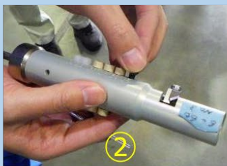
② プランジャーの取付け
