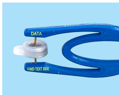
※USBアダプタをiBeeクランプに装着した様子。
