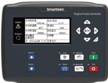
柴驱泵组控制器 Diesel Drive Pump Unit Controller
