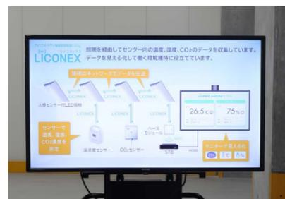
照明のライコネックス網を使ってセンサーから温度・湿度、CO<sub>2</sub>濃度の測定情報を収集。ディスプレイに結果を表示するサービスもテナント様向けプロモーションとして試験的に導入。
