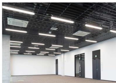
オフィススペースは天井高約3.6mの開放的な空間。事前の照明設計により、デスクワークに十分な机上面照度を確保しています。
