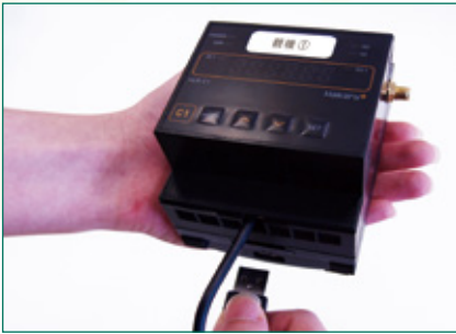
背面のバッテリーに挿すだけで駆動
