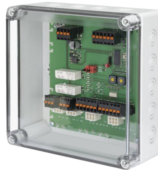
MB-DIO2/1-IP 24 V モジュール(IP65 筐体)は、2つのデジタル入力と1つのリレー出力、MB-DIO4/2-IP 24 V モジュール(IP65 筐体)は、4つのデジタル入力と2つのリレー出力を備え、分散型信号接点の組み込みおよび分散型スイッチングタスクの制御に適しています。
