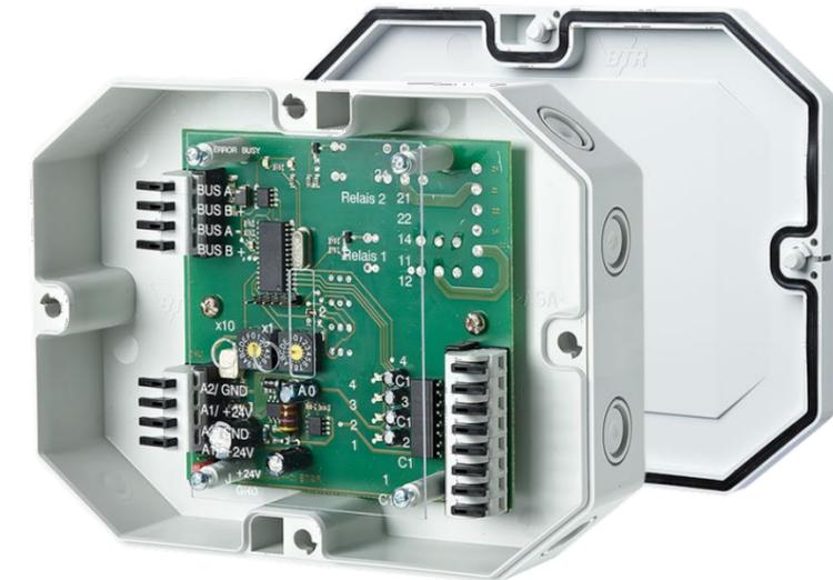
IP65防水防塵構造のBACnet MS/TPモジュール(4デジタル入力)は、分散型スイッチングタスク向けに開発されました。
