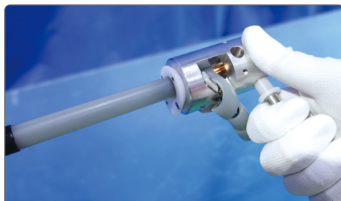
③ 絶縁体剥ぎ取り
