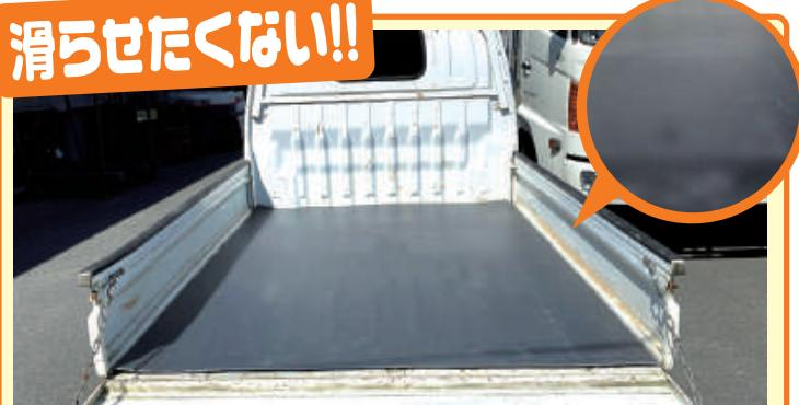
ブラックの表面は溝加工なしで摩擦抵抗が大きく滑りにくい樹脂を利用している為、荷物をしっかりと固定できます!!
