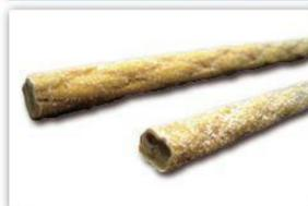
TAF ロッドの表面に珪砂を付着することにより、コンクリートとの付着性をより高められクラックの発生を抑制します。珪砂は純度の高い (99%) ものを使用しています。
